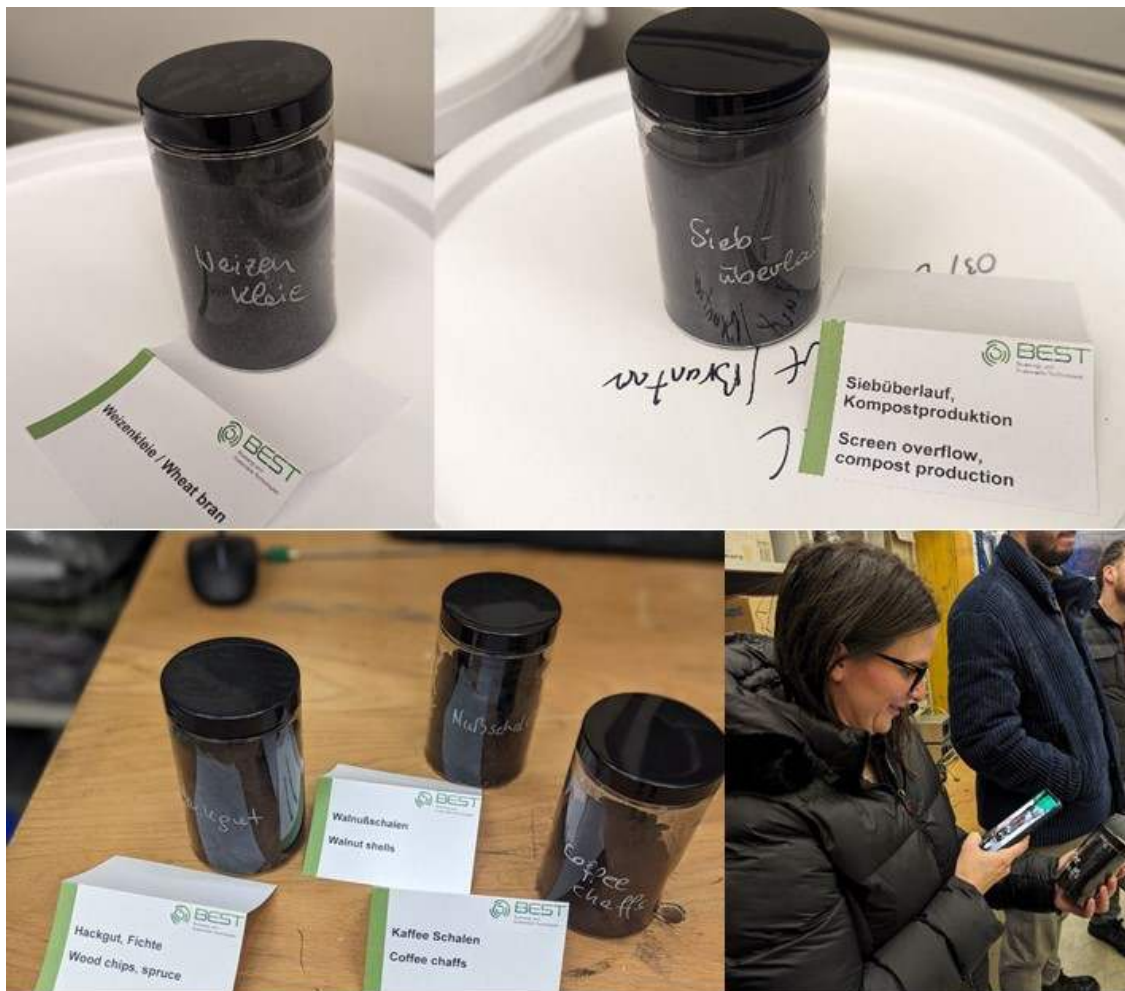
Biooglje proizvedeno iz izbranih biomasnih ostankov | Biochar produced from selected biomass residues
